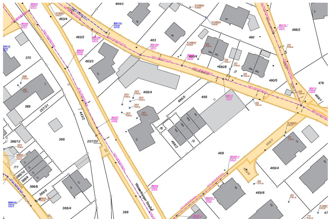
Abb. 17 Kanaldeckelhöhen als Höhenbezugspunkte für die grenzenden Straßenniveaus
