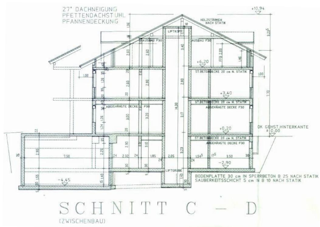
Abb. 9 Querschnitt durch Haus Linde
