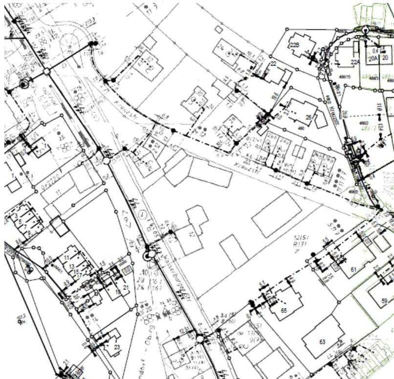
Abb. 3 Telekom Bestandsplan, ohne Maßstab, Quelle: Deutsche Telekom Technik GmbH, Stand 31.10.2022
