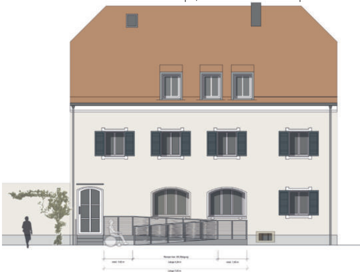
Gewendelte Rampe, max. 6 % + Zwischenpodest
