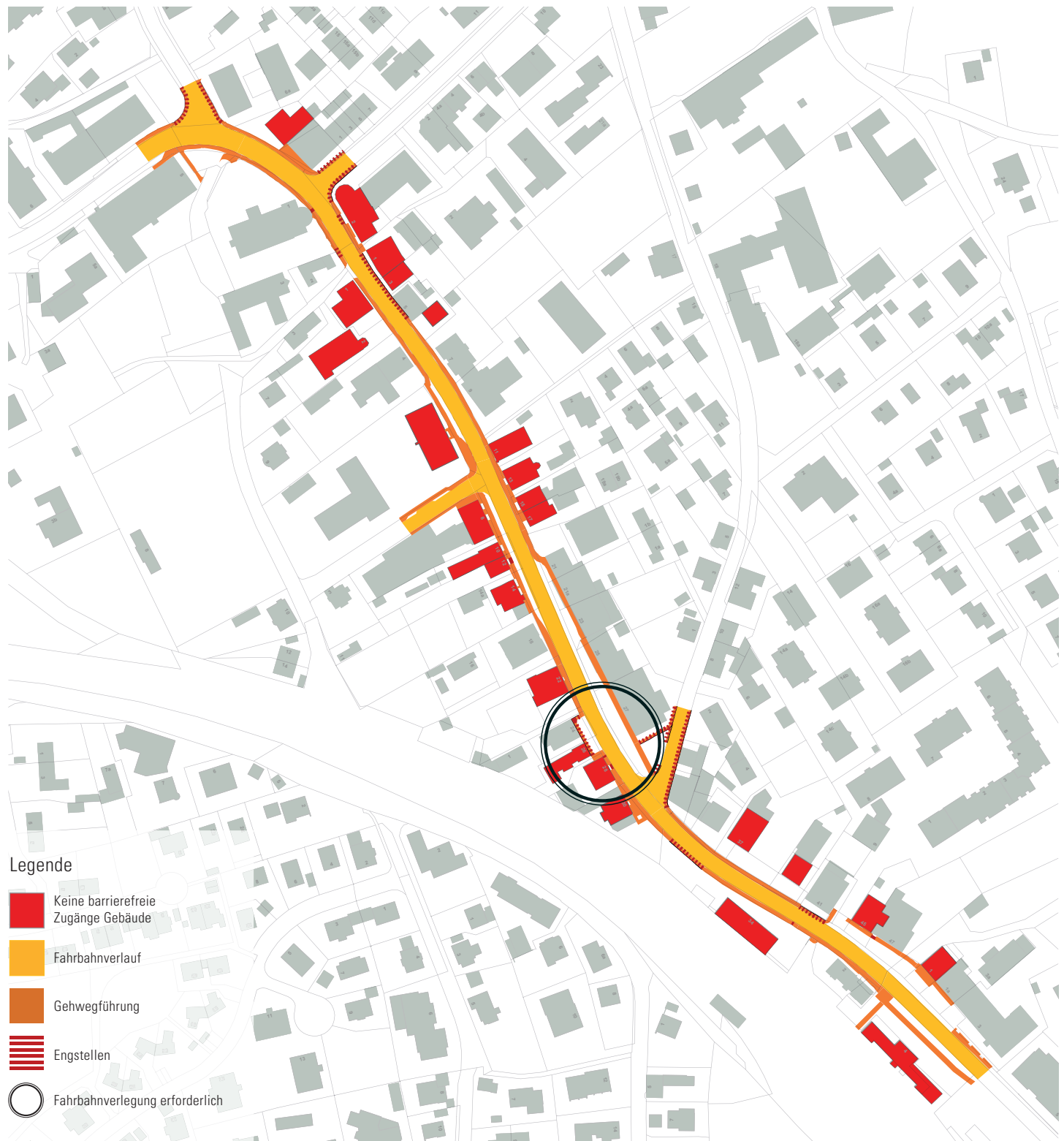
Bestandssituation Bahnhofstraße - Fahrbahnverlauf und Gehwegbreiten, o.M.
