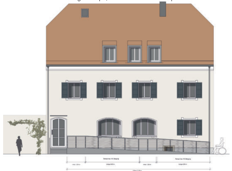
Lange Rampe, max. 6 % + Zwischenpodest
